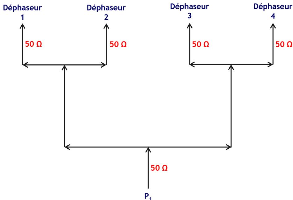
Figure 4.4 : Schématisation du réseau d'alimentation  $1 \rightarrow 4$
