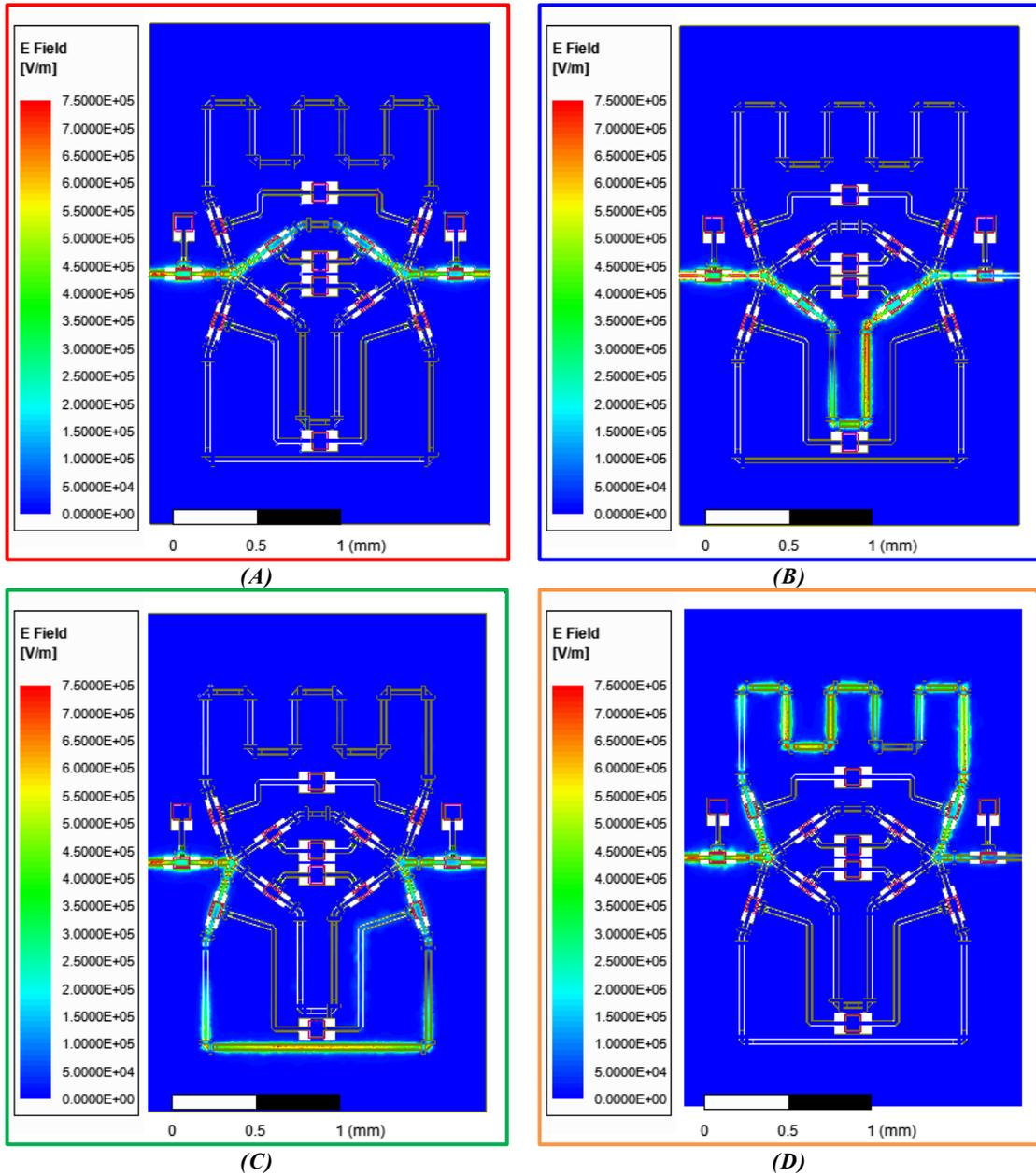
**Figure 4.18** : Cartographie du champ  $E$  pour le déphaseur 2-bits dans ses 4 états : (A) de référence  $0^\circ$  (cadre rouge), (B)  $90^\circ$  (cadre bleu), (C)  $180^\circ$  (cadre vert) et (D)  $270^\circ$  (cadre orange)
