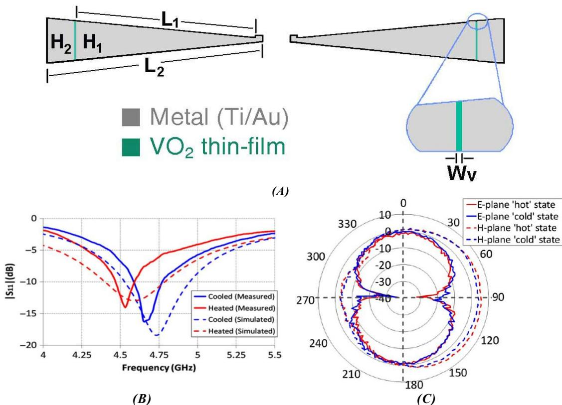
Figure 3.18 : (A) Schéma de l'antenne « bowtie » reconfigurable à base de VO<sub>2</sub>, (B) paramètres S d'adaptation de l'antenne et (C) diagramme de rayonnement en gain [55]
