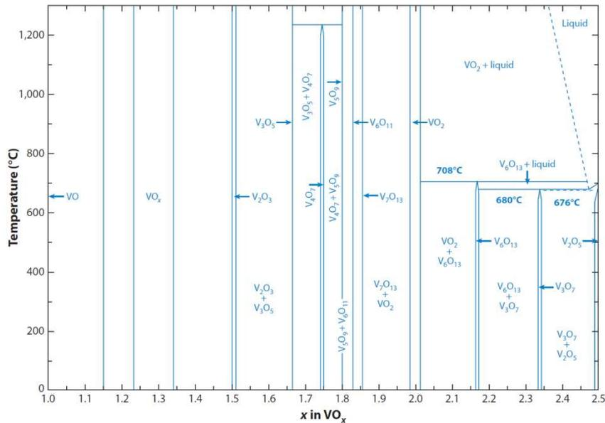
Figure 3.3 : Diagramme de phase des oxydes de vanadium [9]
