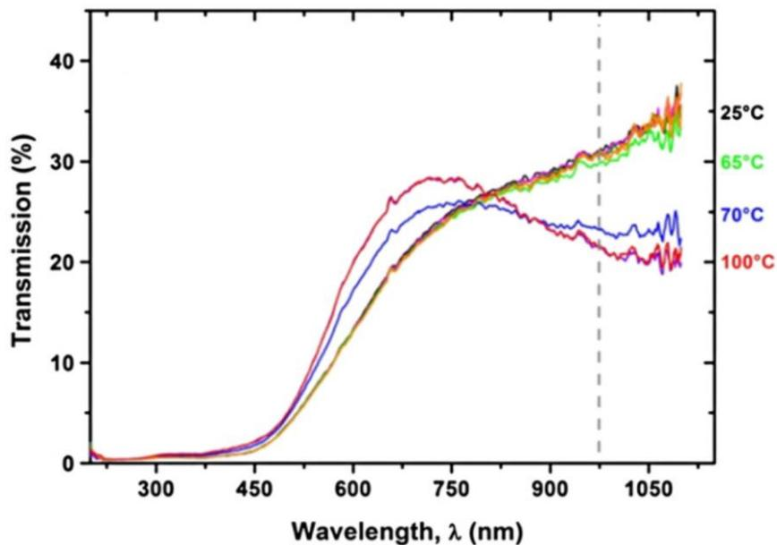
Figure 3.6 : Dépendance de la transmission optique du VO<sub>2</sub> en fonction de la longueur d'onde [24] pour différentes températures
