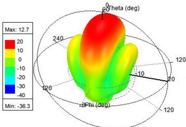
Figure 4.24 : Diagramme de rayonnement en gain réalisé du réseau  $2 \times 4$
