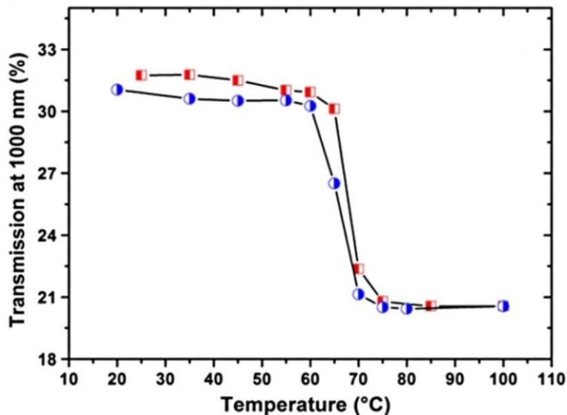
Figure 3.7 : Variation de la transmission optique du VO<sub>2</sub> en fonction de la température [24] pour une longueur d'onde donnée
