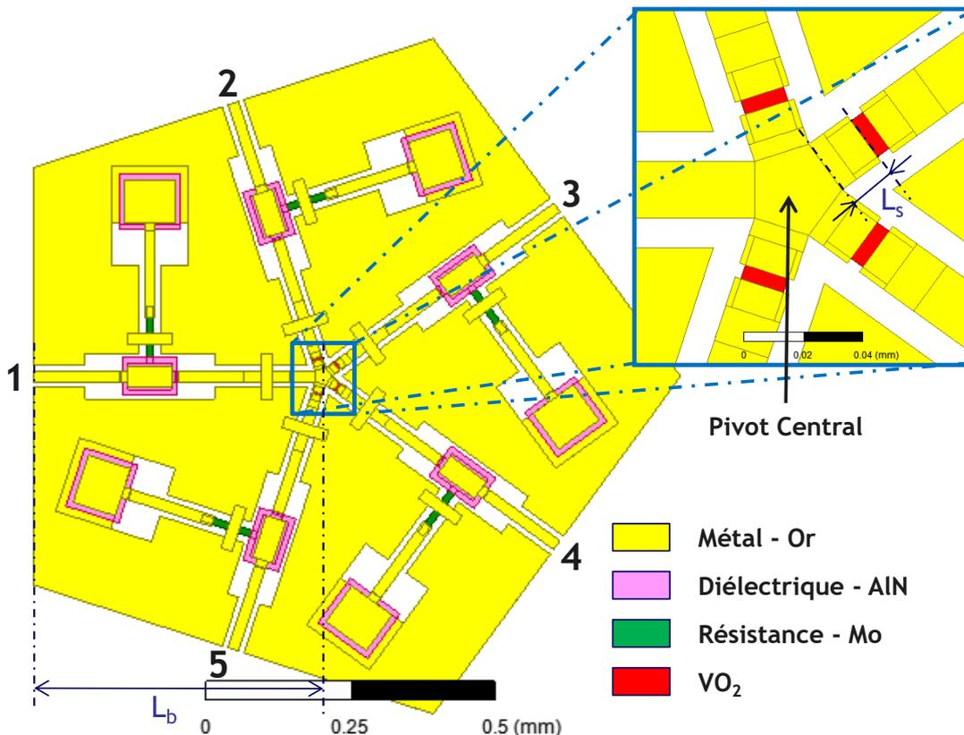
Figure 4.12 : Design du commutateur SP4T à base de VO<sub>2</sub> avec son réseau de polarisation
