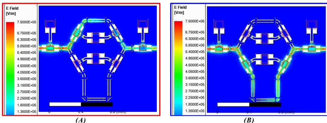
Figure 4.47 : Cartographie des champs électrique dans les deux états du déphaseur 1-bit : (A) état de référence et (B) état de déphasage  $45^\circ$
