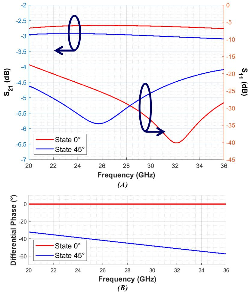
Figure 4.48 : Performances en simulation du déphaseur 1-bit à base de VO<sub>2</sub> : (A) paramètres S et (B) déphasage relatif
