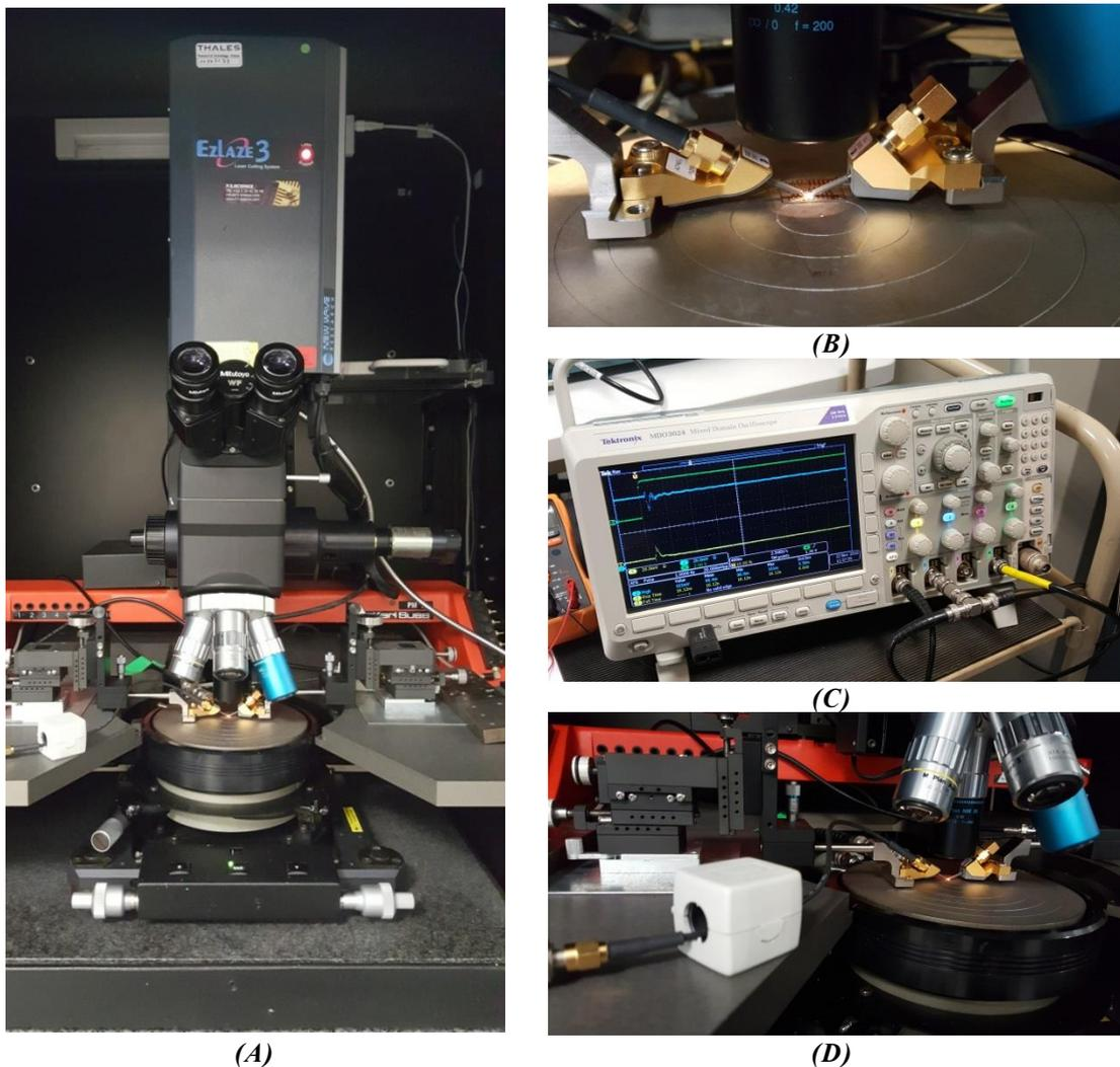
**Figure 3.38** : Photographies des manipulations avec laser réalisées à TRT : (A) le laser et ses objectifs au-dessus de la station sous pointes, (B) zoom sur la station sous pointes, (C) oscilloscope et (D) bagues de ferrites
