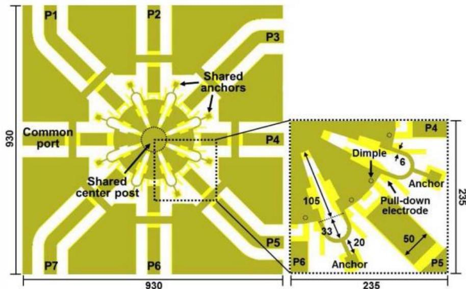
Figure 2.18 : SP7T réalisé à base de MEMS [76]
