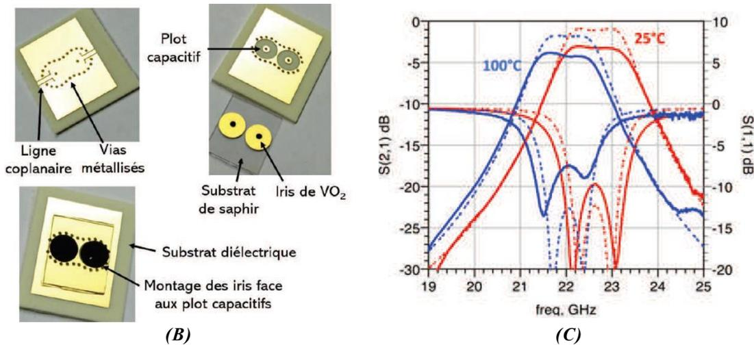
Figure 3.17 : (A) Vue de coupe et des faces supérieure et inférieure, (B) photographie et (C) performances du filtre SIW à base de commutateurs de VO<sub>2</sub> [54]
