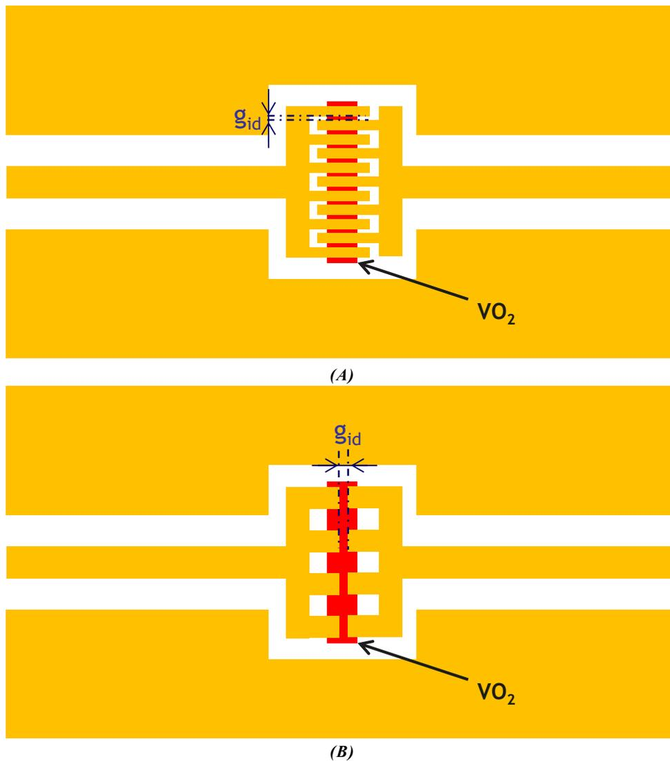
**Figure 4.44** : Schémas de principe de la modification possible de la capacité inter-digitée entre les accès CPW et le motif de VO<sub>2</sub> dans le but de réduire les pertes d'insertion dues au VO<sub>2</sub> : (A) cas d'une grande surface en vis-à-vis et (B) faible surface en vis à vis
