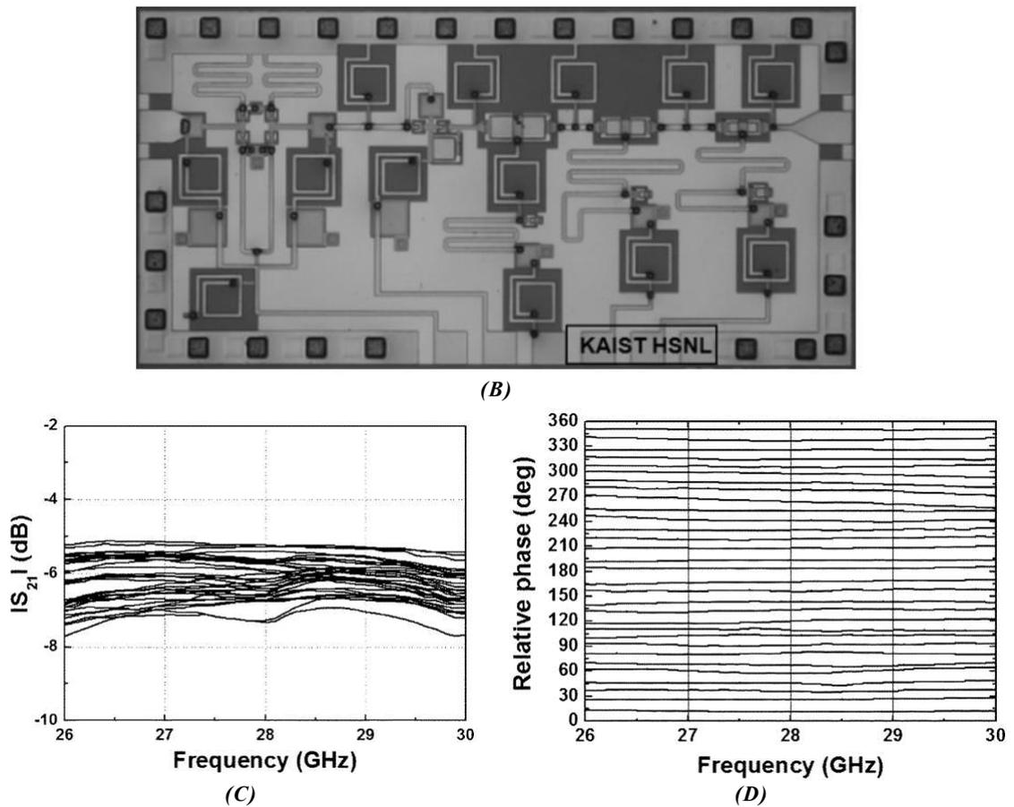
Figure 2.22 : Déphaseur 5-bits MMIC : (A) topologie, (B) photographie du circuit, (C) pertes d'insertion et (D) déphasage relatif [78]
