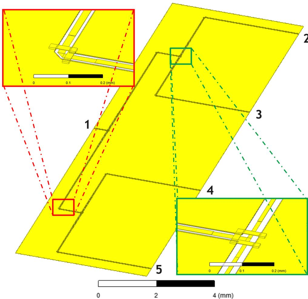
Figure 4.33 : Design du réseau d'alimentation 1 → 4 en technologie CPW
