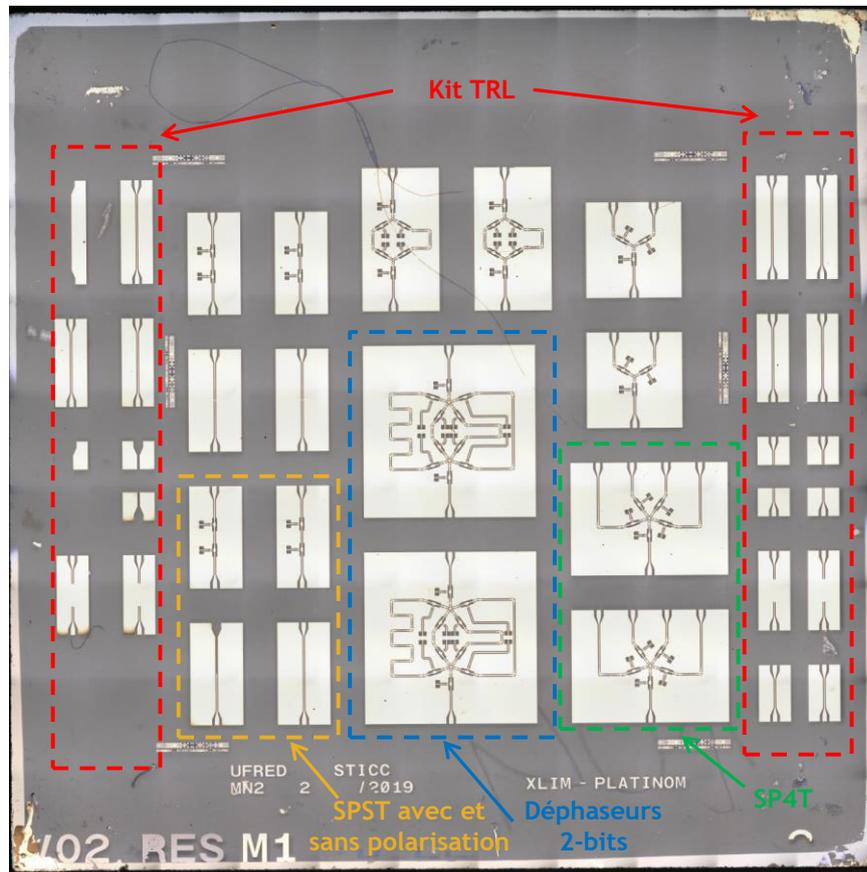
Figure 4.37 : Échantillon de réalisation sur substrat saphir
