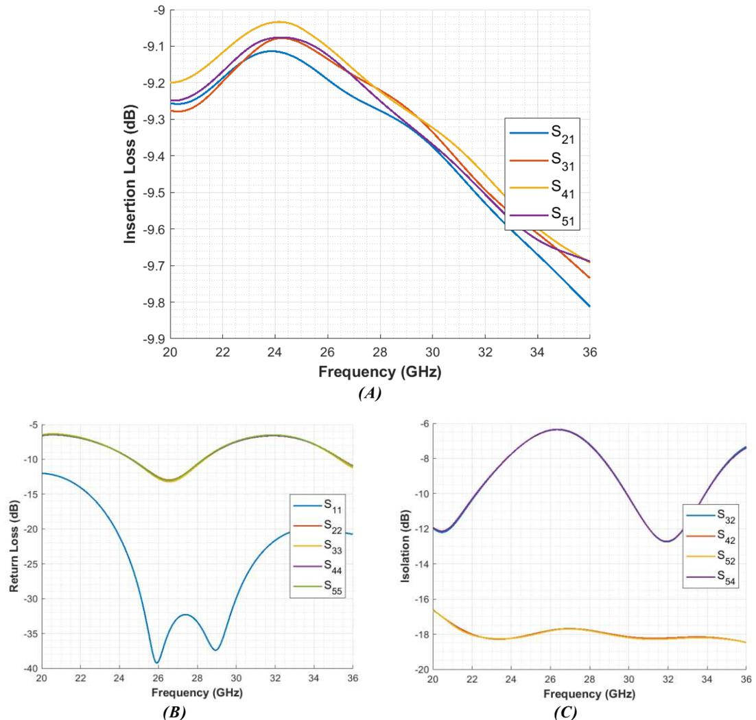
**Figure 4.34 :** Paramètres  $S$  du réseau d'alimentation  $1 \rightarrow 4$  en technologie CPW : (A) pertes d'insertion, (B) coefficients de réflexion et (C) niveaux d'isolation entre les ports de sortie
