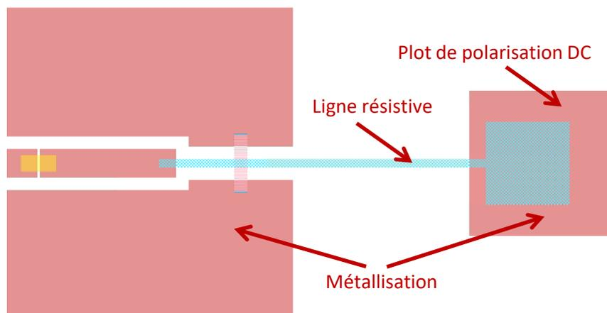
Figure 3.26 : Zoom sur la polarisation électrique du motif de VO<sub>2</sub> au niveau du stub CO–CO
