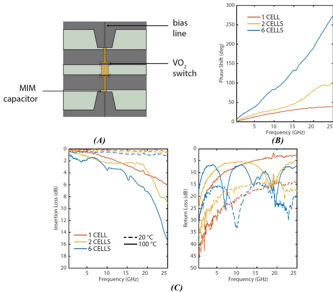
**Figure 3.20** : (A) Schéma d'une cellule déphasante à base de VO<sub>2</sub>, (B) déphasage réalisé par 1, 2 et 6 cellules déphasantes cascadiées et (C) paramètres S correspondants [58]
