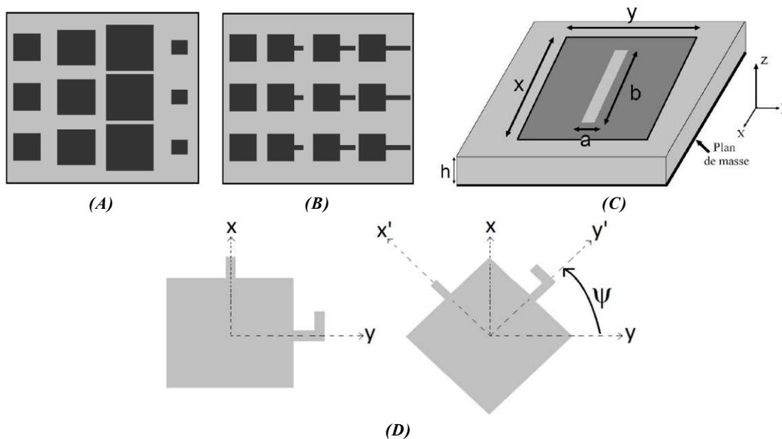
**Figure 2.32** : Illustration des méthodes de contrôle de déphasage des cellules déphaseuses : (A) modification de la taille des éléments rayonnants, (B) ajout de stubs, (C) ajout d'une fente et (D) rotation de l'élément rayonnant [92]
