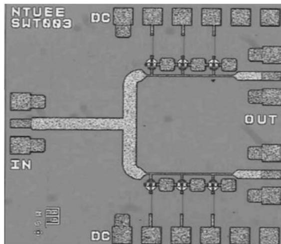
Figure 2.15 : SPDT à base de FET HMET [71]
