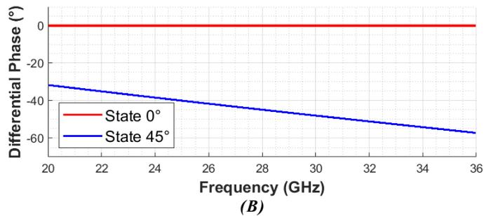
Figure 4.50 : Performances en simulation du déphaseur 1-bit à base de VO<sub>2</sub> compensé : (A) paramètres  $S$  et (B) déphasage relatif
