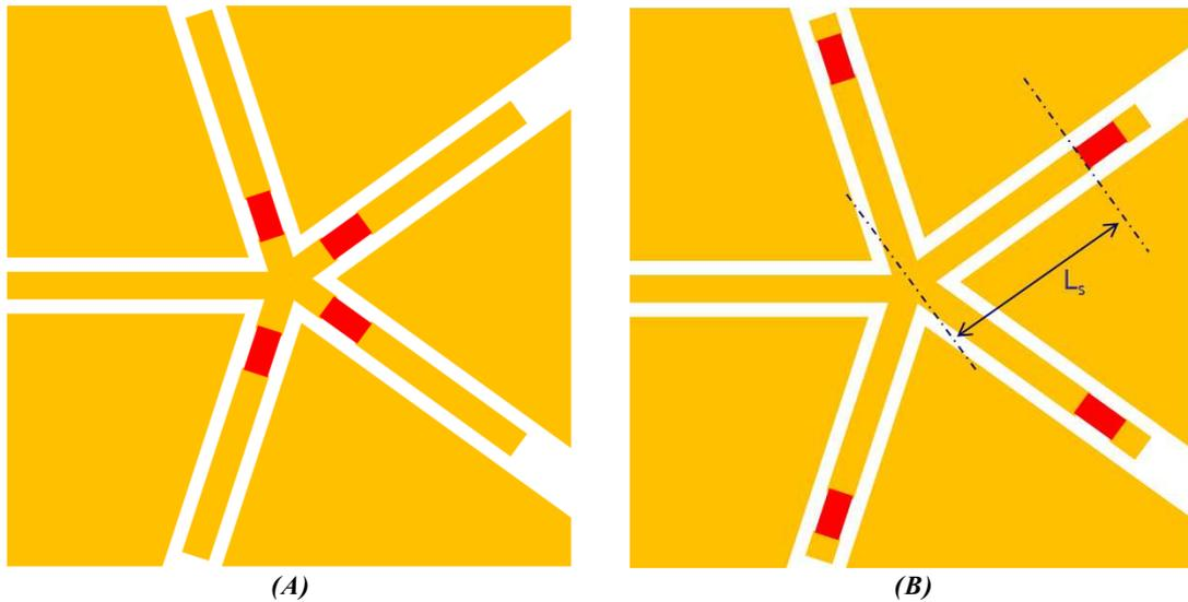
**Figure 4.45 :** Modification possible du contact entre les accès CPW et le motif de VO<sub>2</sub>
