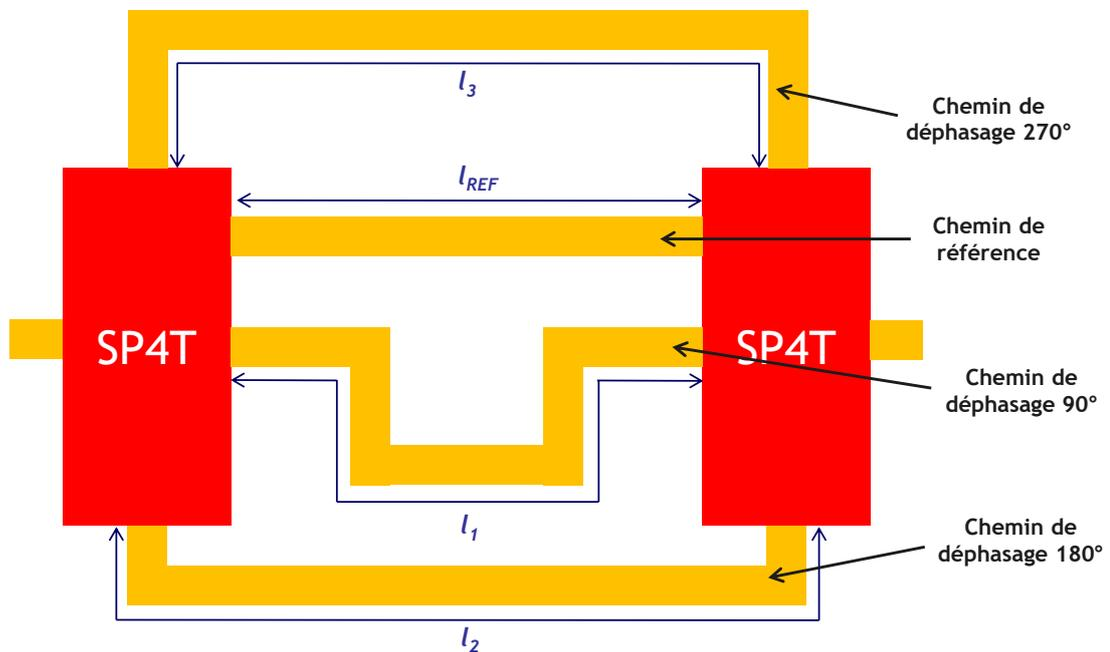
Figure 4.16 : Principe du déphaseur 2-bits (pas de  $90^\circ$ )
