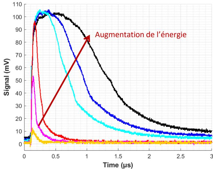
Figure 3.39 : Tension mesurée aux bornes de la résistance pour différentes énergies avec une excitation laser à la longueur d'onde NIR
