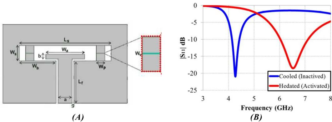
Figure 3.19 : (A) Schéma de l'antenne avec le placement du motif de VO<sub>2</sub> et (B) Paramètres S d'adaptation [56]
