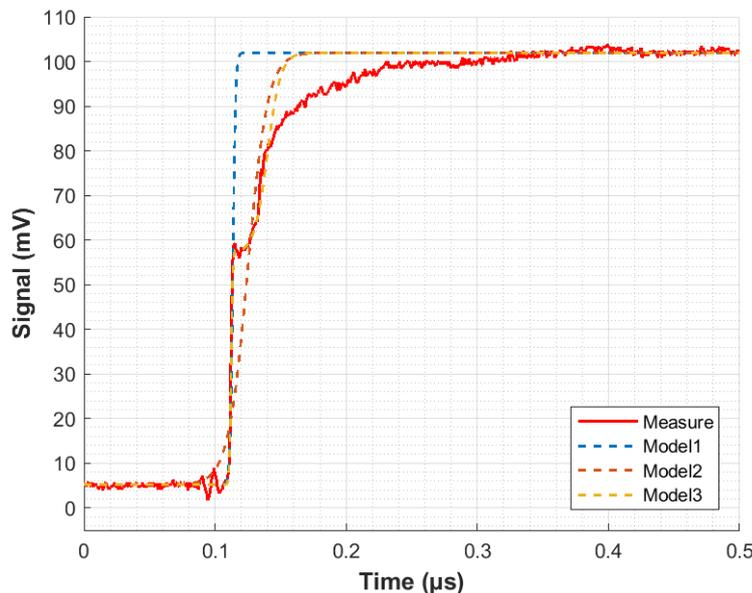
Figure 3.40 : Comparaison avec différents modèles pour le commutateur RF série avec un gap de VO<sub>2</sub> de 10 μm
