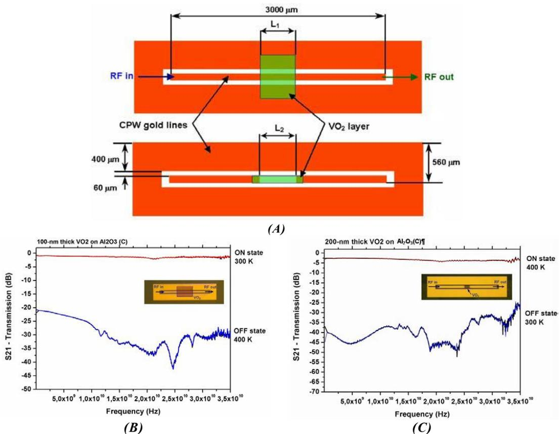
Figure 3.13 : (A) Schéma du commutateur RF en ligne coplanaire dans ses configurations parallèle (haut) et série (bas), (B) paramètre S<sub>21</sub> du commutateur parallèle et (C) du commutateur série [31]
