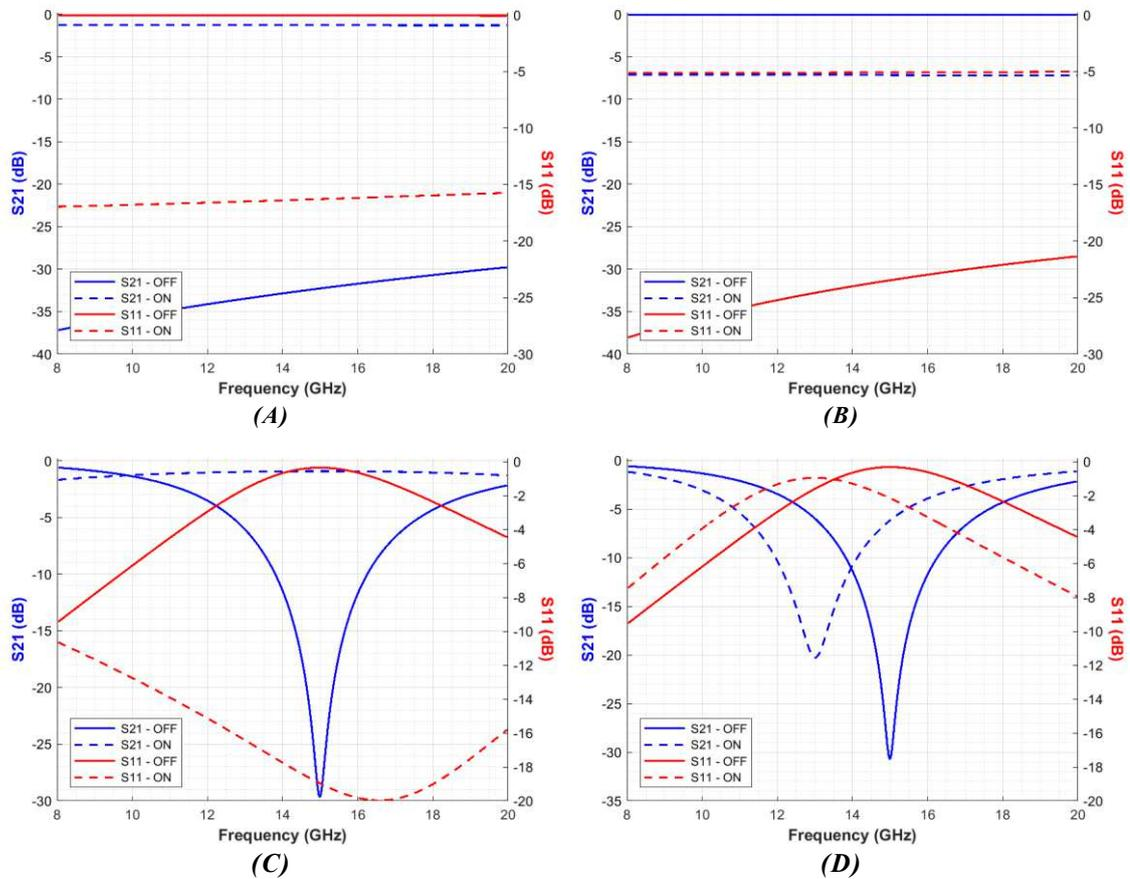
Figure 3.29 : Paramètres  $S$  en simulation des commutateurs RF en configuration (A) série avec un gap de  $5 \mu\text{m}$ , (B) parallèle avec une largeur de  $\text{VO}_2$  de  $10 \mu\text{m}$  et des stubs reconfigurables (C) CO-CC et (D) CO-CO avec un gap de  $\text{VO}_2$  de  $5 \mu\text{m}$
