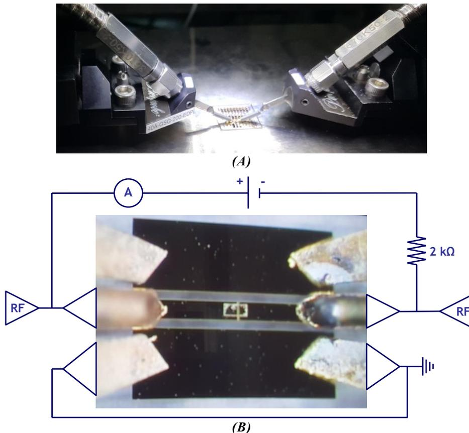
Figure 3.33 : (A) Photographie des pointes GSG posées sur le commutateur RF série et (B) schéma du principe de commande électrique du motif de  $\text{VO}_2$
