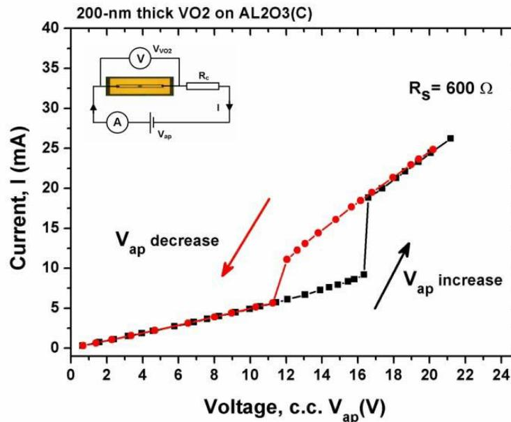
Figure 3.9 : Caractéristique courant vs. tension aux bornes d'un commutateur RF réalisé à l'aide de VO<sub>2</sub> [31]
