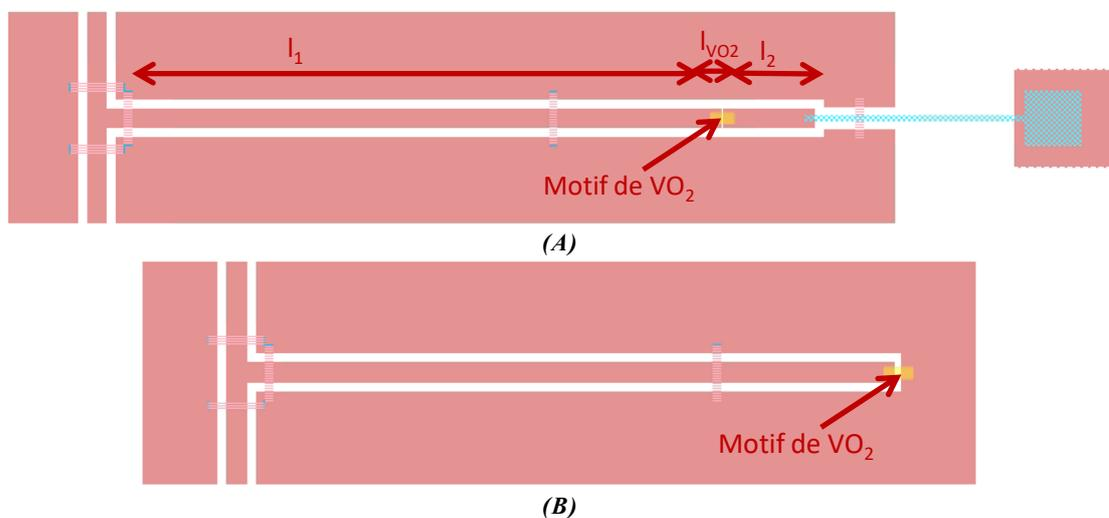
**Figure 3.25 :** Vue de dessus des stubs RF reconfigurables à base de VO<sub>2</sub> en configuration (A) CO – CO et (B) CO – CC
