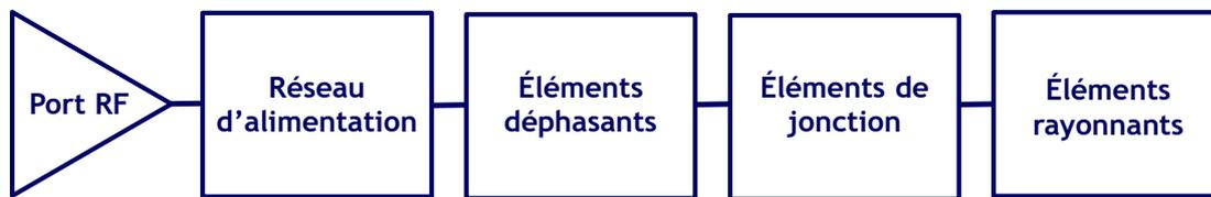
Figure 4.1 : Schématisation par blocs d'un réseau phasé
