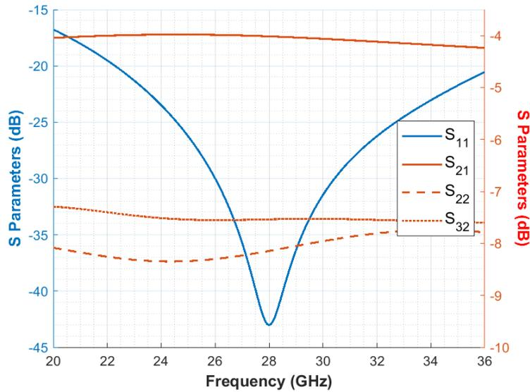
Figure 4.30 : Paramètres S de l'Étage d'Antenne
