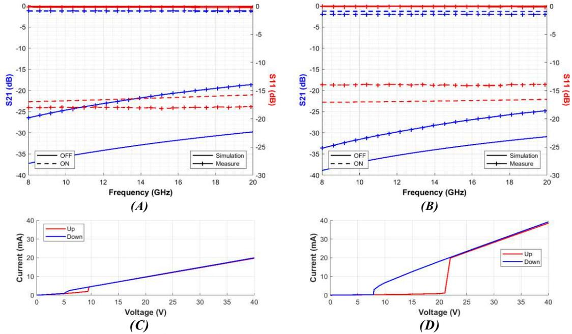
Figure 3.34 : Comparaison des paramètres  $S$  en mesure et en rétro-simulation des commutateurs RF séries avec un gap de  $VO_2$  de (A)  $5 \mu\text{m}$  et (B)  $30 \mu\text{m}$ , courbes caractéristiques I-V correspondantes pour (C)  $5 \mu\text{m}$  et (D)  $30 \mu\text{m}$
