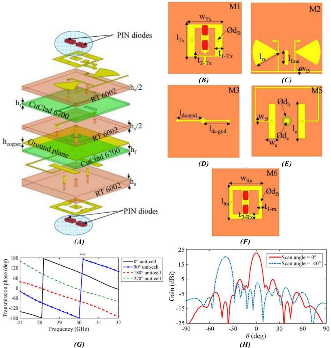
**Figure 2.33** : Illustration de (A) la cellule déphaseuse 2-bits, (B) couche de transmission, (C) couche de polarisation de la partie de transmission, (D) couche de connexion DC au plan de masse, (E) couche de polarisation de la partie réception, (F) couche de réception, (G) phase de  $S_{21}$  en simulation de la cellule unitaire 2-bits et (H) diagramme de rayonnement du réseau transmetteur à 196 éléments unitaires [103]
