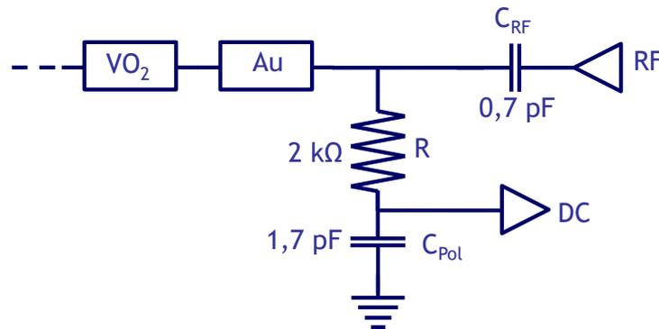
Figure 4.8 : Schéma équivalent du réseau de polarisation
