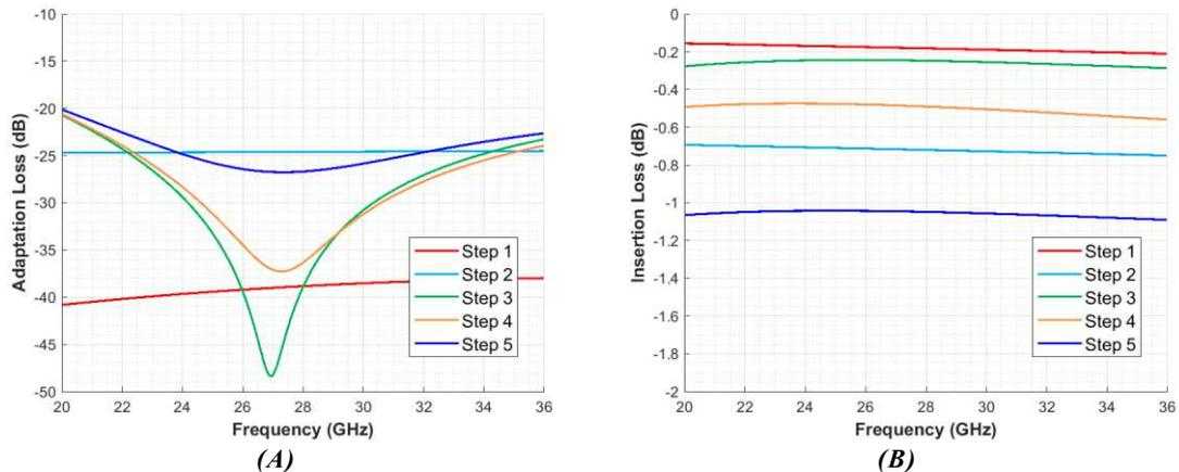
Figure 4.9 : Paramètres RF simulés lors des 5 étapes de conception du commutateur SPST à l'état ON (VO<sub>2</sub> dans son état métallique) : (A) coefficients de réflexion et (B) pertes d'insertion
