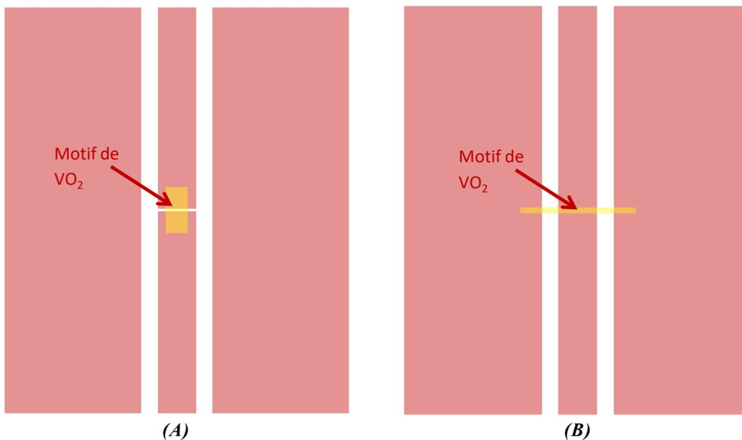
Figure 3.24 : Vue de dessus des commutateurs RF à base de VO<sub>2</sub> en configuration (A) série et (B) parallèle
