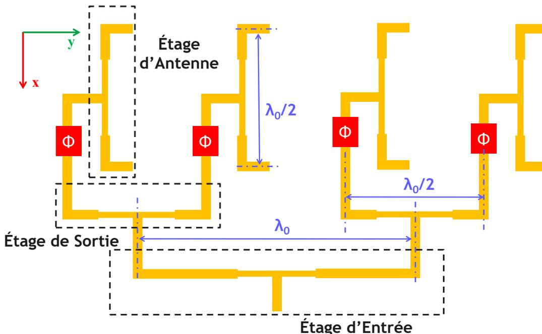
Figure 4.28 : Schéma du circuit d'excitation des antennes
