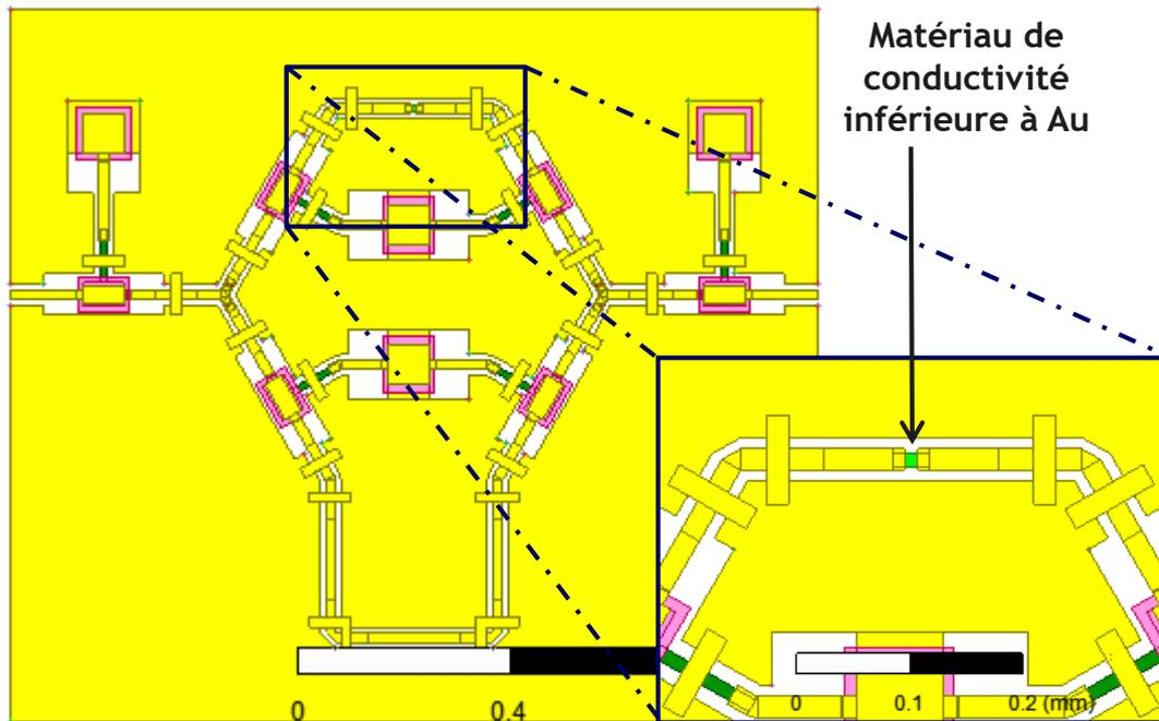
Figure 4.49 : Introduction de pertes supplémentaires de compensation dans le chemin de référence du déphaseur 1-bit
