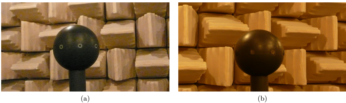
FIGURE 1.4 – Sphère rigide incluant 8 microphones omnidirectionnels de modèle DPA 4060 (a) ou de modèle Schoeps CCM 2 (b).
