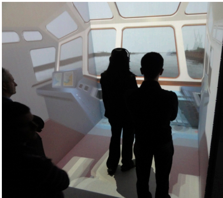
FIGURE 1.9 – Simulateur de démonstration représentant un poste de pilotage naval virtuel.
