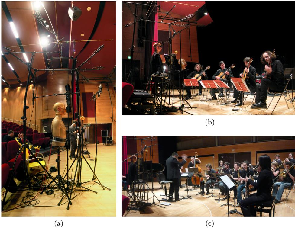
FIGURE 1.1 – Dispositifs microphoniques positionnés dans la salle du tambour (a) afin de capter un quatuor de guitares (b) et un big band de jazz (c).
