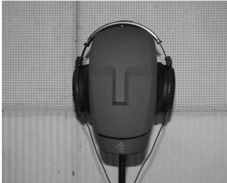
FIGURE 2.6 – Casque Sennheiser HD 600 (modèle D ) positionné sur la tête artificielle Neumann KU 100.
