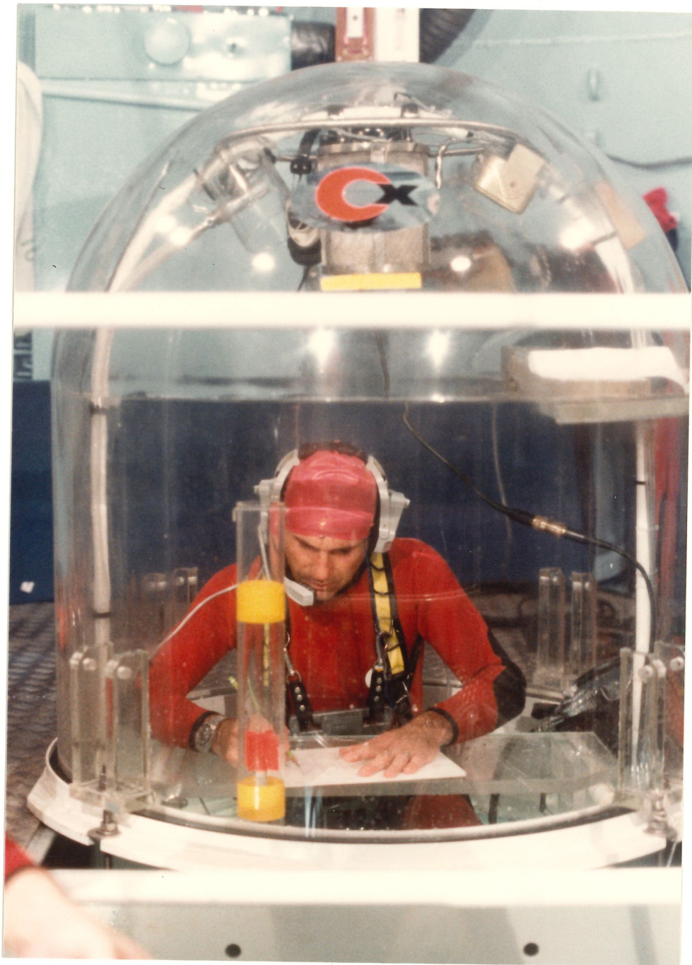
M. GIRAUD EFFECTUE LE TEST DES MULTIPLICATIONS SOUS LA COUPOLE EN ATMOSPHERE HYDROX 98/2
