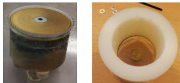
Fig. 1. Sonde coaxiale ouverte incluant un réservoir.
