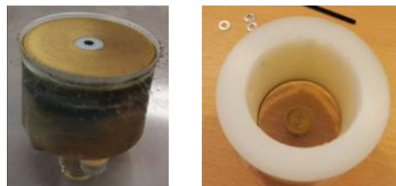
Fig. 1. Sonde coaxiale ouverte incluant un réservoir.
