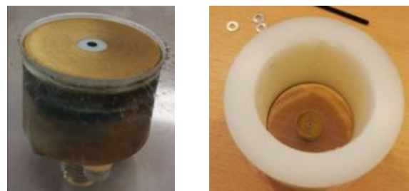
Fig. 1. Sonde coaxiale ouverte incluant un réservoir.
