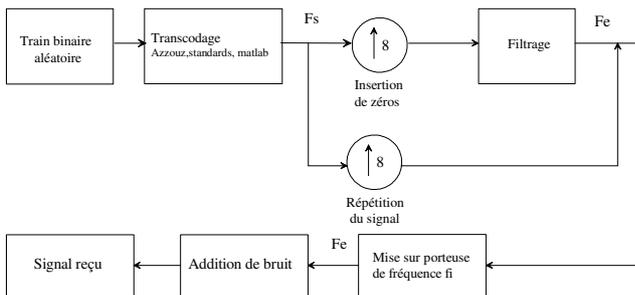
Le message initial est à la fréquence symbole de 1MHz. Il subit un transcodage selon le type de modulation choisi. Le signal est ensuite suréchantillonné soit en insérant des zéros, soit en répétant le signal. Suréchantillonner le signal augmente la période dans le domaine fréquentiel, ce qui permet un décalage en fréquence ou une mise sur porteuse ici à 3MHz. On ajoute alors du bruit pour représenter le milieu de transmission. C'est le signal qui est reçu ou intercepté.
