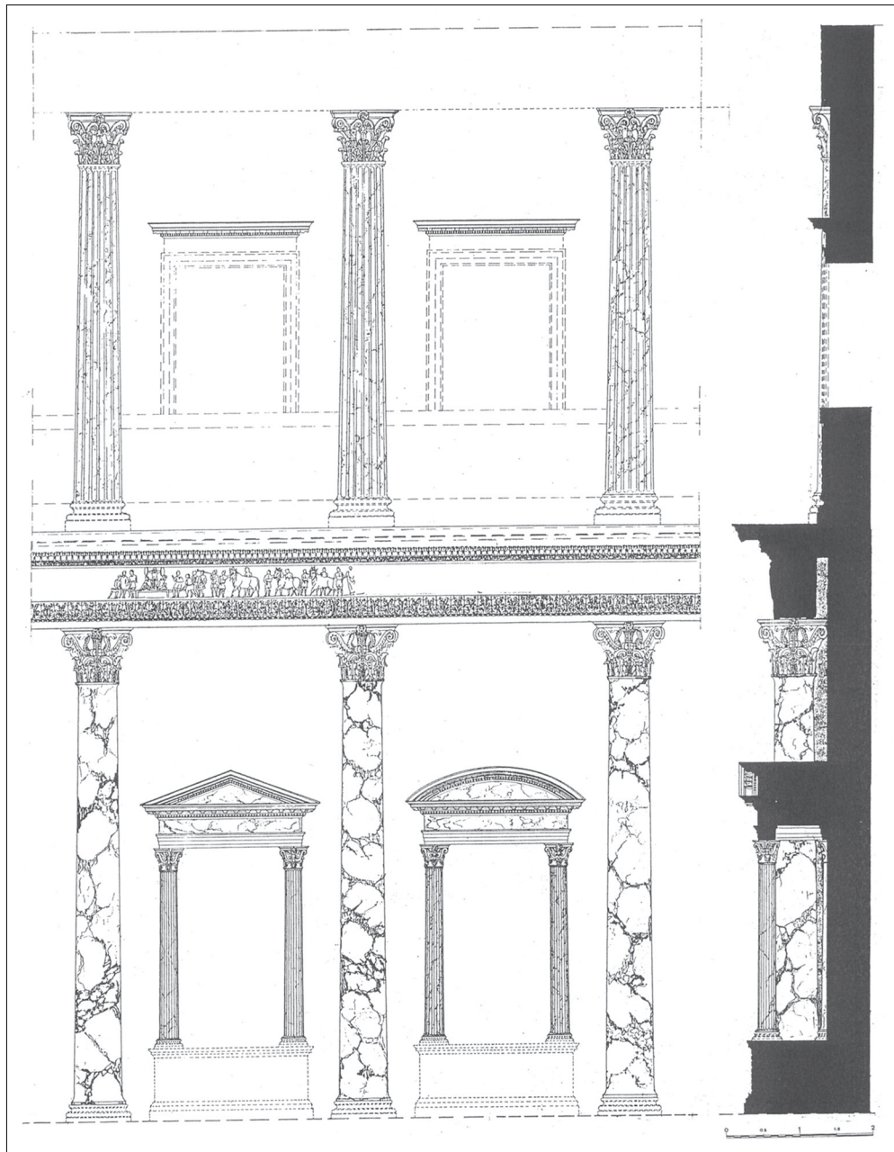
Fig. 2 : Rome, Temple d'Apollo in circo , restitution des ordres superposés de la cella (d'après A. Viscogliosi, 1996, fig. 188).
