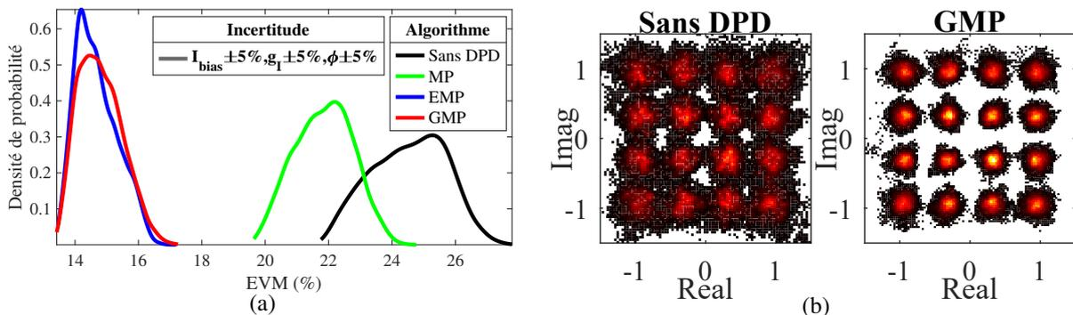
FIGURE 2 – (a) Densité de probabilité de l’EVM pour une configuration 16-QAM à  $P_{ref,SOA} = -17\text{dBm}$  (b) Constellation 16-QAM sans DPD et avec GMP
