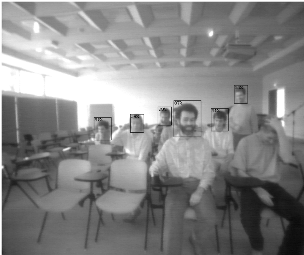
FIG. 8: Détection et localisation automatique de visages
