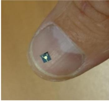
Figure 4 : Photographie du circulateur planaire auto-polarisé en bande Q.
