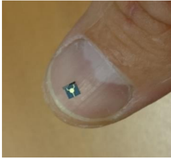
Figure 4 : Photographie du circulateur planaire auto-polarisé en bande Q.
