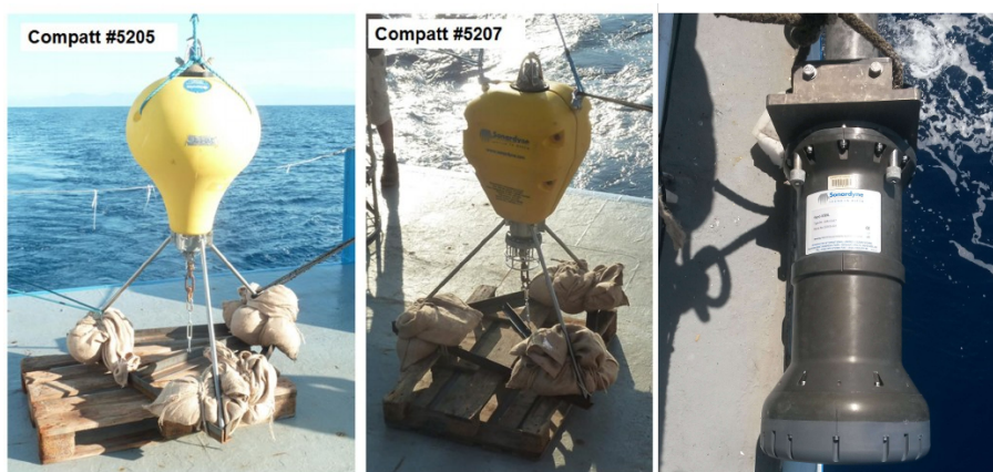
Figure 3 : Équipements utilisés lors de la campagne GEODESEA, avant déploiement : balises acoustiques fond de mer insérées dans leur bouée et montées sur des trépieds lestés et tête acoustique associée à une centrale d'attitude (à droite).
