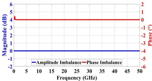
Figure 11. Différences d'amplitude et de phase entre les deux sorties du diviseur de puissance
