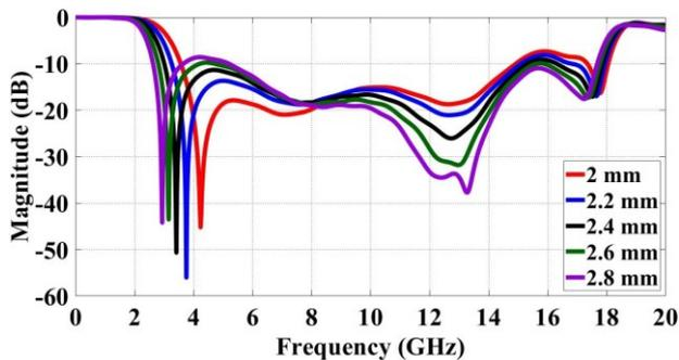
**Figure 6. Module de  $S_{11}$  de la transition Zinieris en fonction du rayon  $R_s$  du stub fente**
