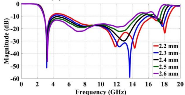
**Figure 5. Module de  $S_{11}$  de la transition Zinieris en fonction du rayon  $R_m$  du stub microruban**
