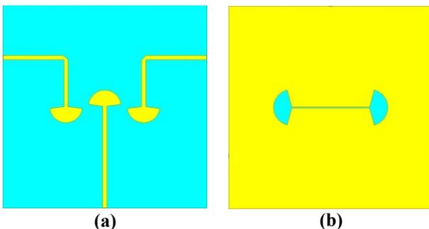
Figure 3. Diviseur de puissance : (a) vue de dessus (b) vue du plan de masse.
