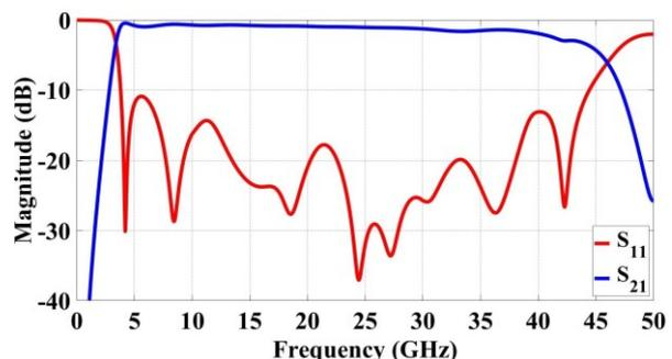
**Figure 9. Paramètres S de la transition optimisée**
