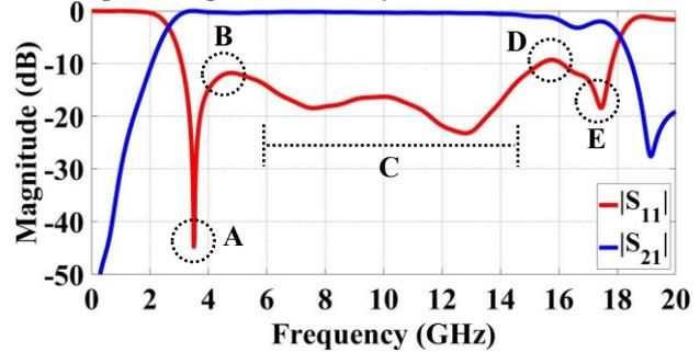
Figure 4. Paramètres S de la transition Zinieris
