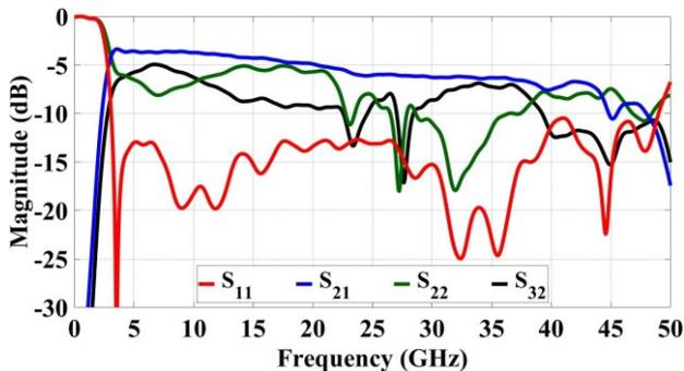
Figure 10. Paramètres S du diviseur de puissance proposé
