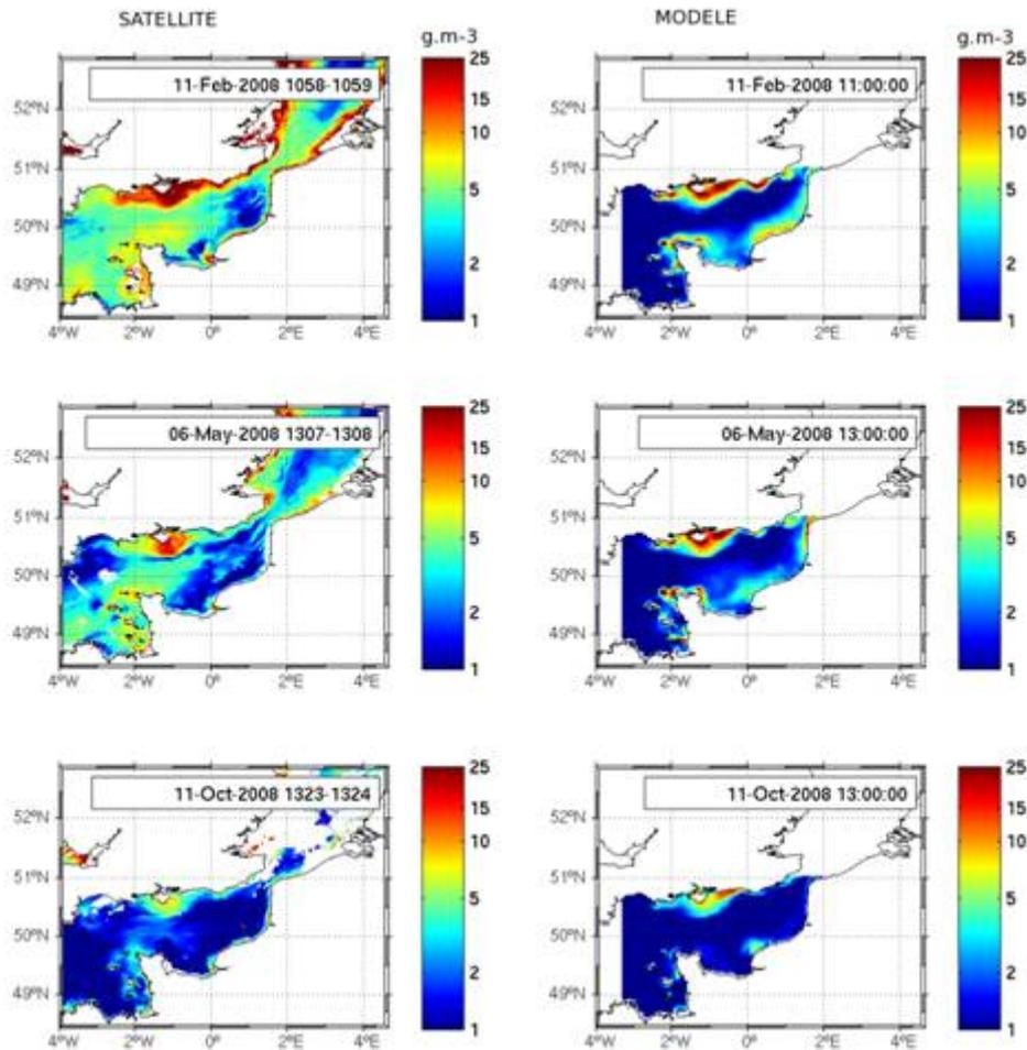
Figure 4. Comparaison satellite (gauche) – modèle (droite) de la CSS en surface (en  $\text{g m}^{-3}$ ) les 11 février, 6 mai et 11 octobre 2008.
