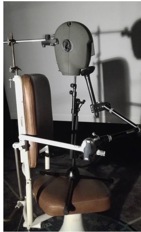
FIGURE 2 – Position de la tête artificielle (maintenue par l'appui-tête et la mentonnière) lors de l'enregistrement des stimuli.
