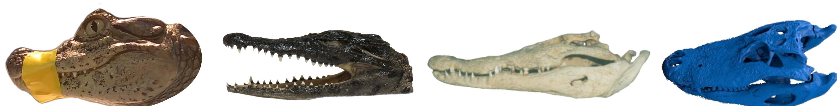
Fig.4 : Différents matériels utilisés pour les mesures de HRTF. De gauche à droite : crocodiliens vivants, têtes de crocodiliens taxidermées, crânes de crocodiliens, crânes de crocodiliens imprimés en 3D.
