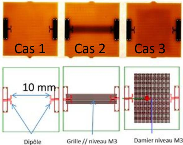
Figure 1. Exemples de circuits PCB multicouches réalisés sur un substrat diélectrique Megtron 6.
