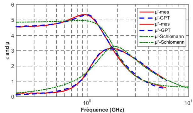
Figure 3 Confrontation mesure/théorie de la perméabilité avec différents modèles théoriques.
