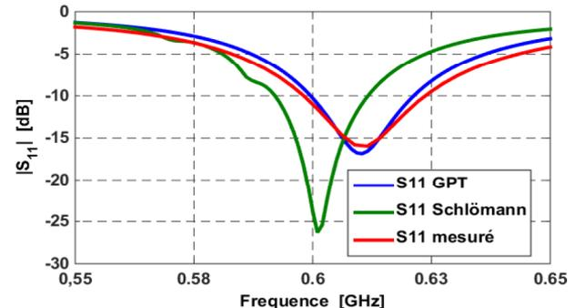
Figure 4 Confrontation simulation-mesure pour le coefficient de réflexion  $S_{11}$  dans le cas du ferrite désaimanté.
