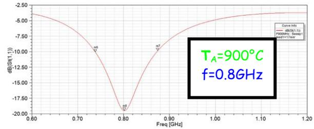
Figure 3a. Coefficients de réflexions (HFSS) d'antennes patch réalisées sur le matériau S3 ( $T_A=900^\circ\text{C}$ ).
