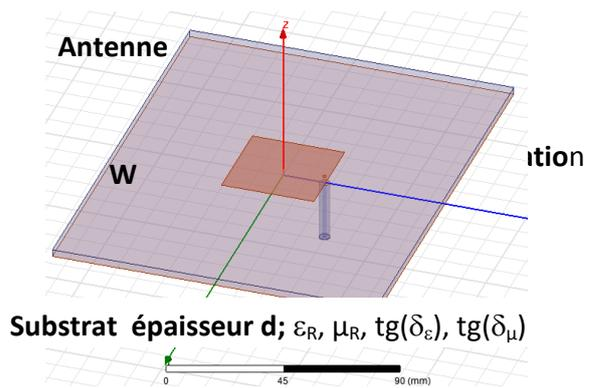
Figure 2. Antenne patch modélisée.
