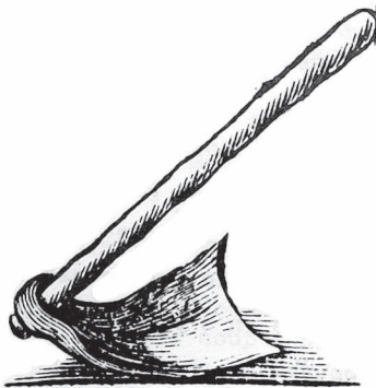
Fig. 1 : « Une espèce de tranche recourbée, de seize pouces de long et de huit pouces et demi de large par en bas, d'où la largeur va toujours en diminuant jusqu'après du manche, où elle se trouve réduite à trois pouces », Louis F. H. de MENON, marquis de TURBILLY, Mémoire sur les défrichemens , Paris, 1761 (cf. François SIGAUT, L'agriculture et le feu , op. cit., p. 55 pour la citation, p. 58 pour le croquis).
