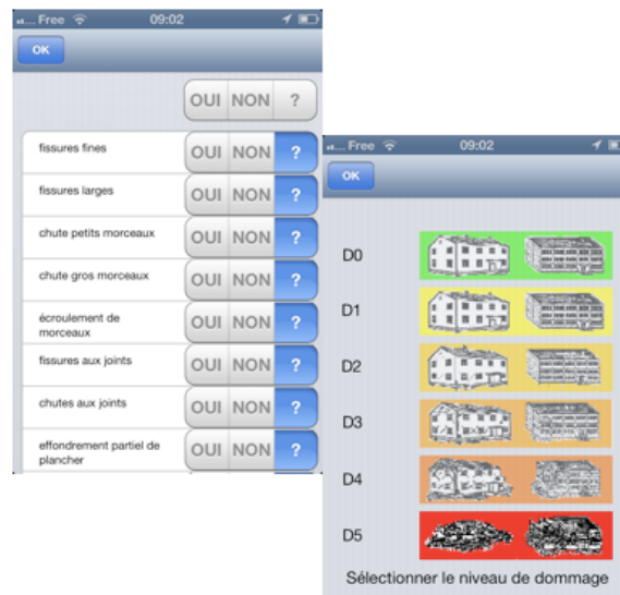
Figure 4 : IsibatMobile, principales fonctionnalités en mode Dommege : Edition des paramètres (figure gauche) ; Sélection du type de dommege (figure droite) .
