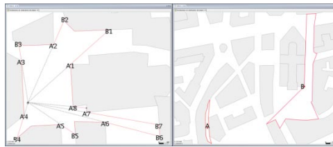
Figure 4. (gauche) Dans l'isovist associé au point de vue O , les points A_i matérialisent les huit occlusions associées à O et les points B_i les arrières plans correspondants. (droite) Deux situations extrêmes pour l'indicateur d'anticipation.
