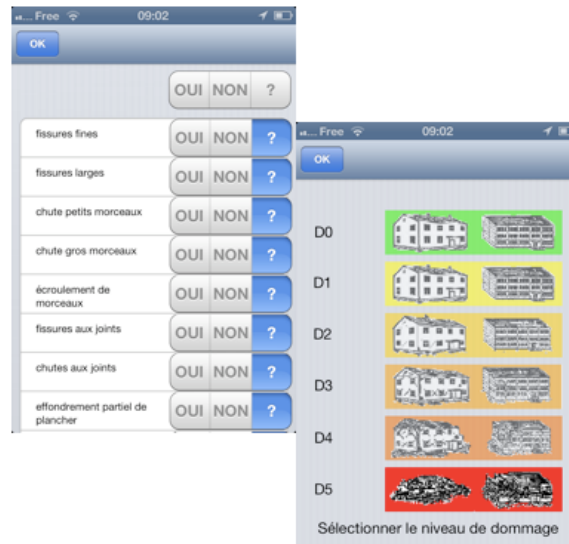
Figure 4 : IsibatMobile, principales fonctionnalités en mode Domage : Edition des paramètres (figure gauche) ; Sélection du type de dommage (figure droite) .
