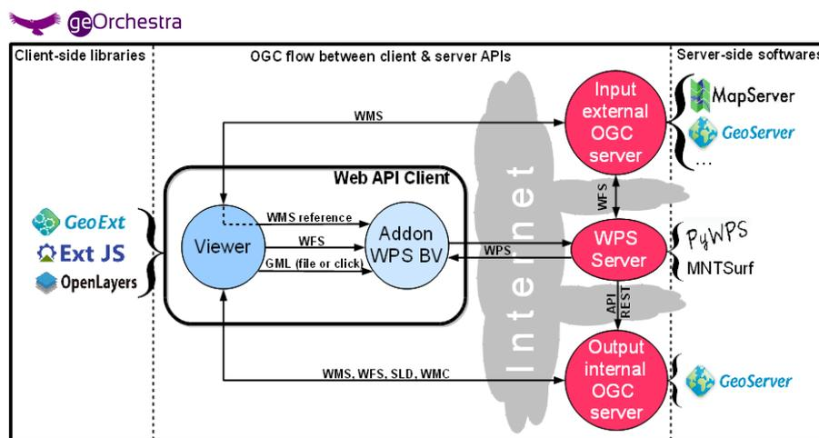
Figure 1. Schéma fonctionnel synthétique de l'architecture intégrant l'addon et le WPS BV.
