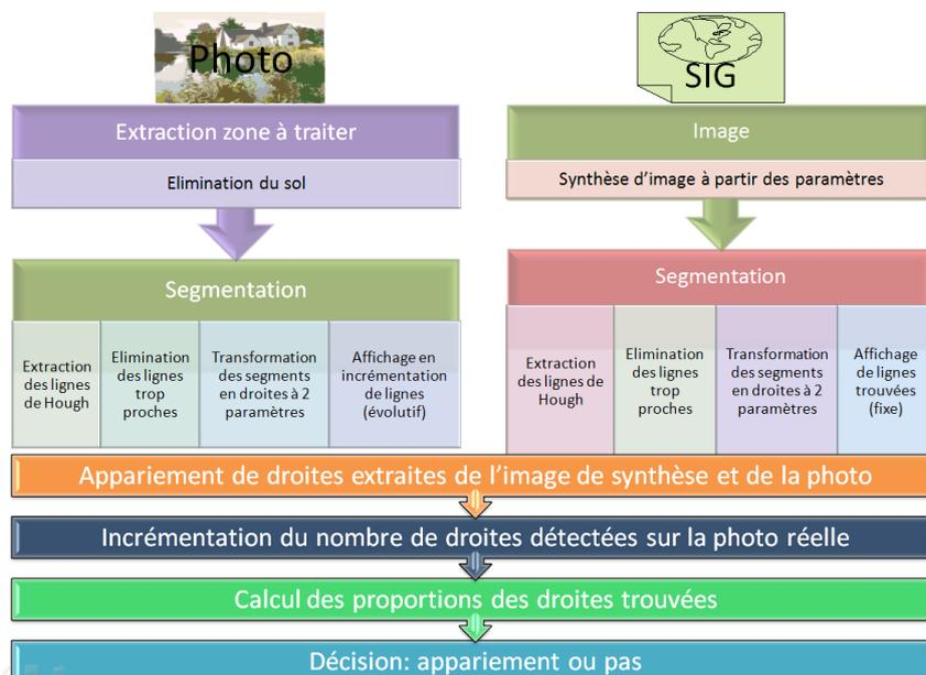
Figure 1. La démarche d'interface par appariement de lignes
