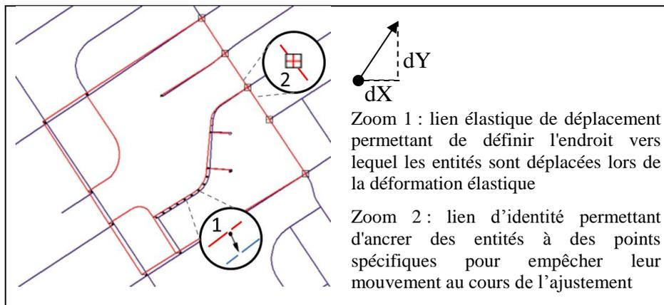
Figure 3. Principe du deuxième géoréférencement par déformation élastique d'ajustement spatial utilisant des liens de déplacement et des liens d'identité.
