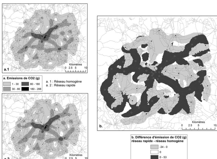
Figure 5. Emission de CO<sub>2</sub> (g) - a.1 réseau homogène; a.2 réseau rapide; b. différence d'émission de CO<sub>2</sub> (rapide – homogène)
