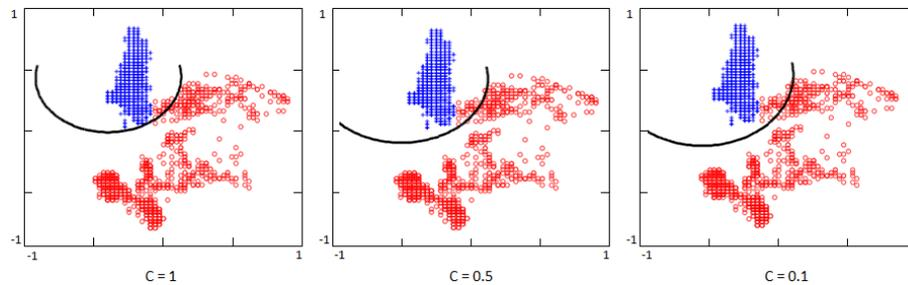
Figure 5. Impact du paramètre de régularisation  $C$  sur la procédure d'apprentissage pour l'extrait 1. Les pixels d'apprentissage de la classe positive sont représentés en bleu et les pixels de la classe négative sont représentés en rouge. La ligne noire représente la limite de décision trouvée par le détecteur SVDD.
