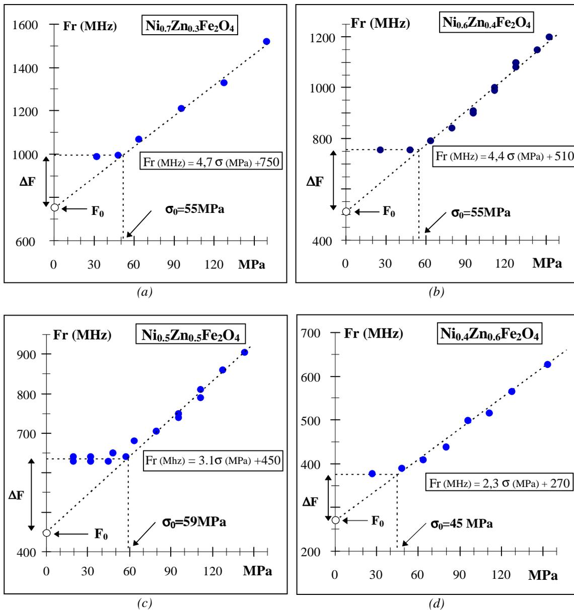
figure 3 : variation de la fréquence de résonance en fonction de la pression appliquée lors du matriçage pour des compositions de ferrites de Nickel-Zinc.  $\sigma_0$  est le seuil de contrainte appliquée à partir duquel la fréquence commence à augmenter.  $\Delta F$  mesure l'écart de fréquence due aux contraintes internes initiales.
