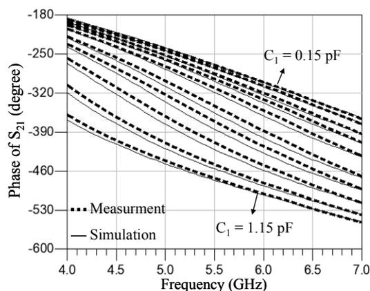
Figure 7 : comparaison des phases mesurées et simulées
