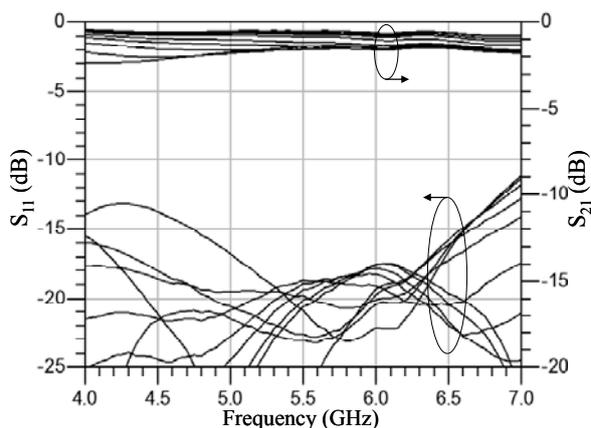
Figure 6 : paramètres  $S_{11}$  et  $S_{21}$  mesurés
