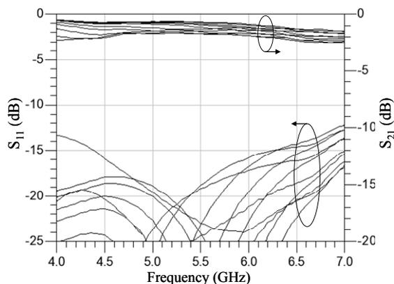
Figure 4 : simulations après optimisation des paramètres  $S_{11}$  et  $S_{21}$  à partir des valeurs mesurées de la varicap MA46H120
