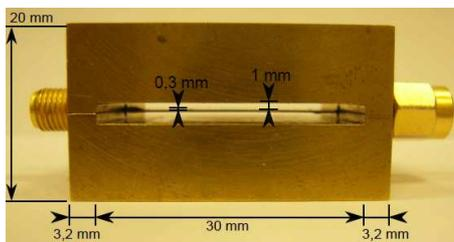
Figure 3 : Dimensions de la cellule de mesure
