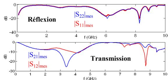
Figure 7 : paramètres S mesurés pour la forme 2
