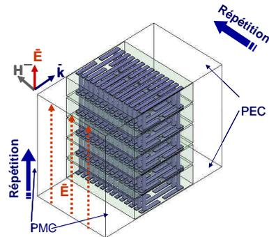
Figure 5. Structure en augmentant plusieurs cellules dans les deux directions.
