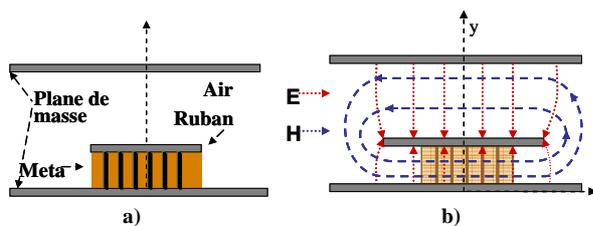
**Figure 1.** a) Ligne triplaque asymétrique.
