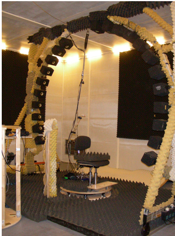
Figure 2.3 – Ensemble de haut-parleurs utilisés pour la mesure de HRTF. Le sujet est positionné sur la chaise au milieu du cercle de haut-parleur.
