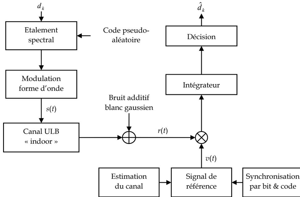
FIG. 1 – Architecture générale du système IR-UWB utilisé
