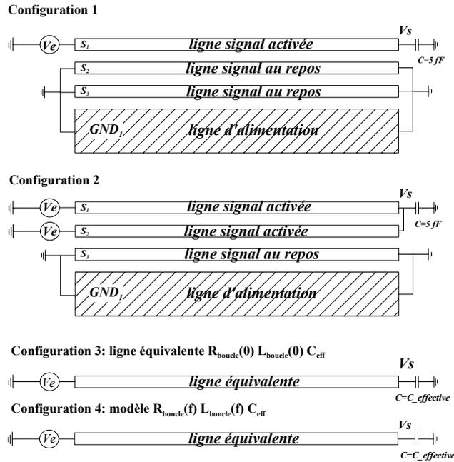
**Fig. 3 – Configuration 1: Schéma d'excitation de la ligne signal 1. Configuration 2 : schéma d'excitation des lignes signal 1 et 2. Configuration 3 : ligne équivalente avec éléments constants calculés en basse fréquence. Configuration 4 : modèle équivalent fréquentiel.**
