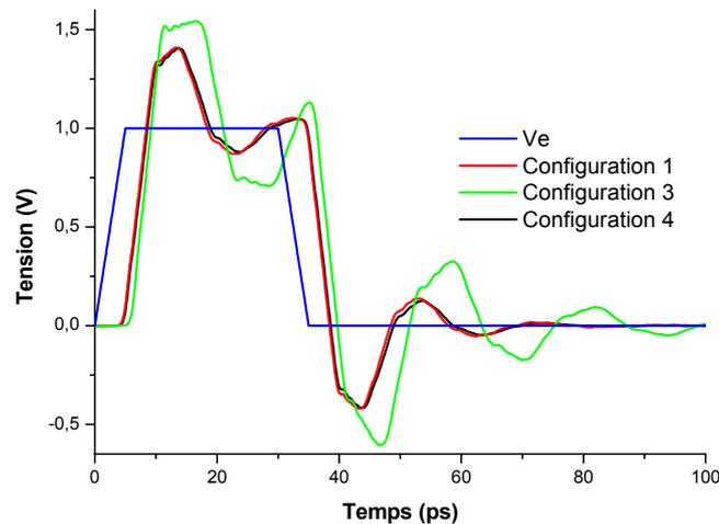
**Fig. 4- Evolution temporelle de la tension de sortie dans la configuration 1 comparée à la ligne équivalente à éléments constants (configuration 3) et au modèle fréquentiel (configuration 4) pour une interconnexion de 700  $\mu m$  de longueur et un signal d'entrée de temps de transition  $t_r$  égal à 5ps.**
