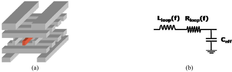
Fig. 1 – Exemple de réseau d'interconnexions (à gauche) et le modèle équivalent (à droite).
