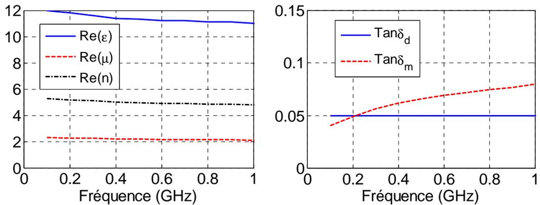
Figure 3 : Paramètres effectifs du matériau MF-114
