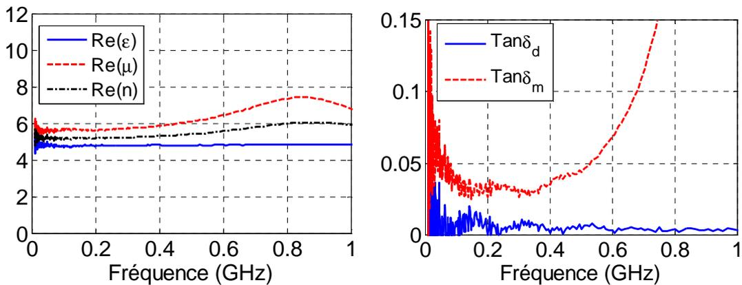
Figure 2 : Paramètres mesurés du substrat M2
