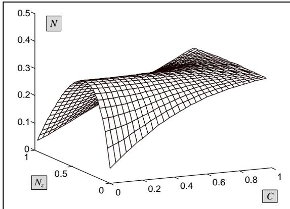
Figure 1: variation du coefficient effectif de forme  $N$  en fonction de la concentration en matière magnétique  $C$  et de la forme  $N_z$  des particules pour  $\chi_i=20$
