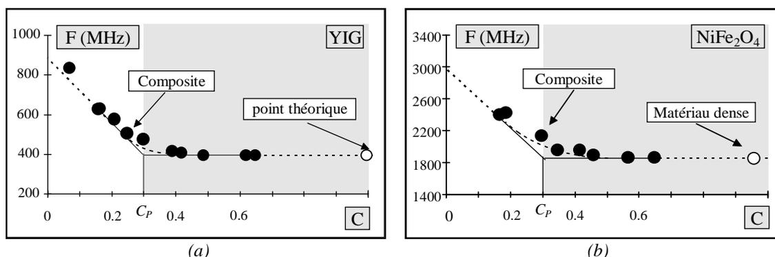
figure 4 : variation de la fréquence de gyrorésonance en fonction de la concentration. Mise en évidence de la concentration seuil  $C_p$ . Les points (●) sont les résultats expérimentaux (maximum de  $\chi''$ ), les lignes brisées (---) représentent la variation théorique issue de l'équation (1).
