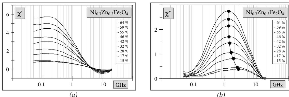
figure 3 : variation expérimentale de la susceptibilité réelle et imaginaire en fonction de la concentration pour des composites à base de ferrite de Nickel Zinc ( $Ni_{0.7}Zn_{0.3}Fe_2O_4$ )
