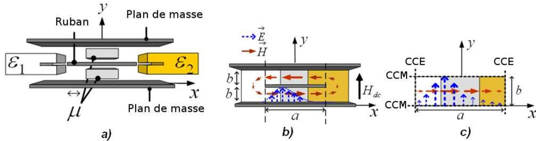
Fig. 2. a) Ligne triplaue. b) Carte des champs pour la propagation directe. c) Structure théorique équivalente
