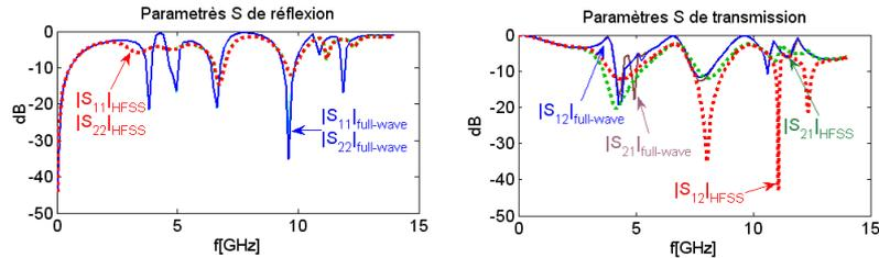
Fig. 4. Comparaison des paramètres  $S$  du problème direct avec ceux issus du logiciel HFSS pour une ferrite saturé ( $4\pi Ms=1200$  G,  $Ha=380$  Oe,  $\epsilon=14,9-j0,01$ ,  $\tan(\gamma)<2\cdot 10^{-4}$ ,  $H_{dc}=2kOe$ )  $\epsilon_1=1,07-j0,01$  (mousse)  $\epsilon_2=15,5-j0,01$  ( $TiO_2$ ).
