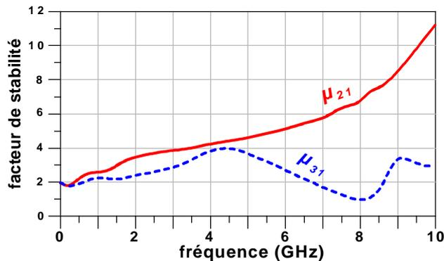
Figure 6. Facteurs de stabilité  $\mu_{21}$  et  $\mu_{31}$  des branches 1-2 et 1-3 du Balun simulé.
