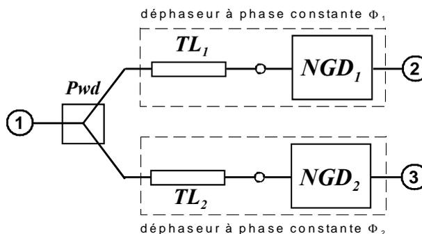
Figure 3. Architecture du Balun actif à phase constante.
