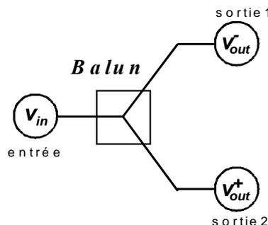
Figure 2. Représentation schématique d'un Balun à 3 ports.
