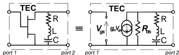
Figure 1. Cellule active à TPG négatif et son modèle en basse fréquence.
