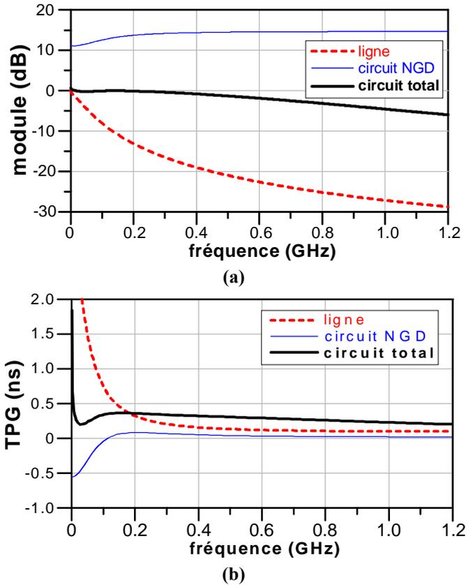
Figure 7. Réponses fréquentielles du circuit de la Figure 6 : (a) en gain et (b) en TPG.
