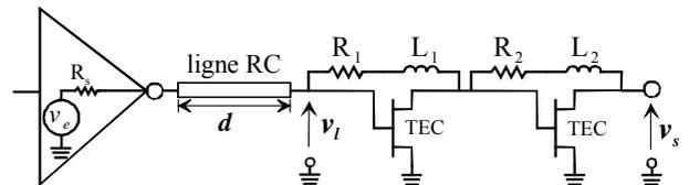
**Figure 4. Ligne RC alimentée par une porte ayant une résistance de sortie  $R_s = 90 \Omega$ , compensée par deux étages de cellules NGD ( $R_1 = 91 \Omega$ ,  $L_1 = 40$  nH,  $R_2 = 110 \Omega$ ,  $L_2 = 20$  nH, TEC/EC-2612).**
