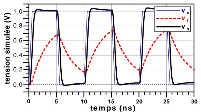
Figure 8. Réponses temporelles du circuit de la Figure 6 pour une entrée trapézoïdale de débit 200 Mbit/s.
