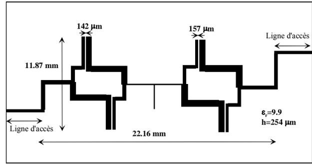
**Figure 7** Schéma du deuxième filtre modifié d'ordre 4.
