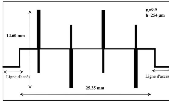
**Figure 5** Schéma du filtre classique d'ordre 4.
