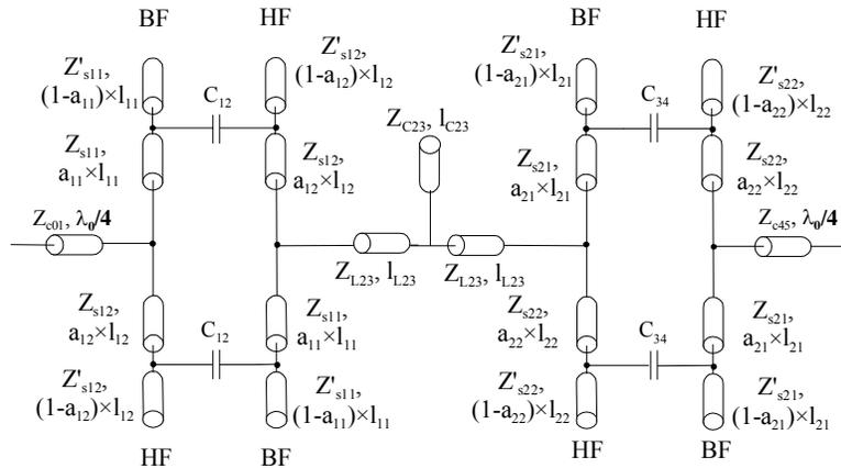
**Figure 2** Filtre DBR modifié d'ordre 4 en lignes idéales.
