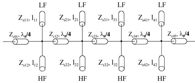
**Figure 1** Filtre DBR classique d'ordre 4 en lignes idéales.
